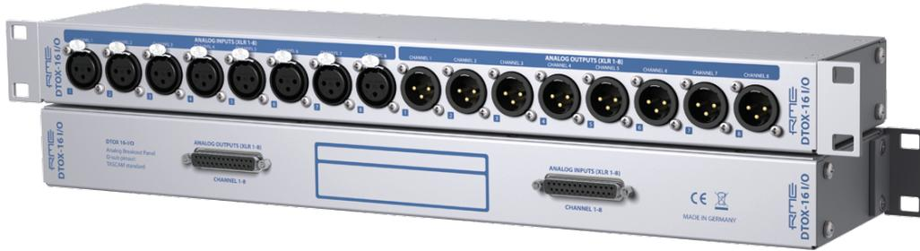
Die DTOX-16 Breakout-Konsolen sind optimale Rack-Lösungen, um mehrkanaliges Audio von D-sub Anschlüssen in XLR Male/Female umzusetzen. Drei Versionen sind erhältlich: DTOX-16 I, DTOX-16 O und DTOX-16 I/O. DTOX-16 verbindet bis zu 16 Eingänge oder Ausgänge (XLR-Neutrik-Anschlüsse) mit zwei 25-poligen D-sub-Anschlüssen.
